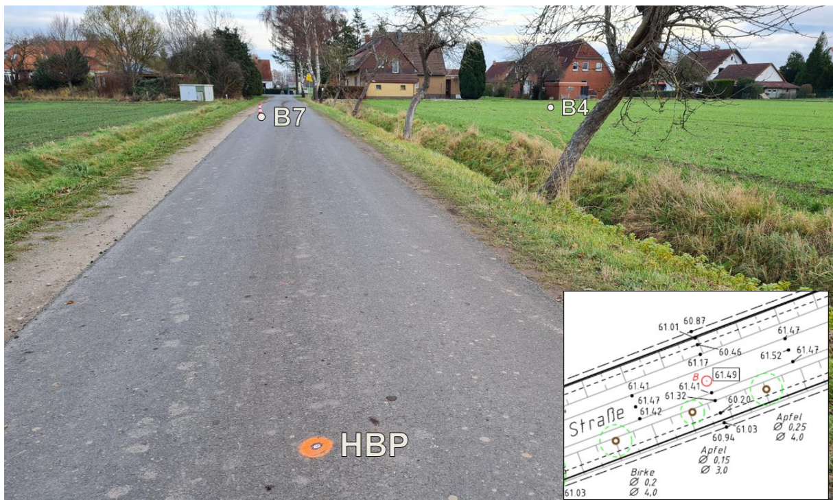
Bild 5H – Lage des Höhenbezugspunktes (HBP = B mit 61,49 m NHN)
